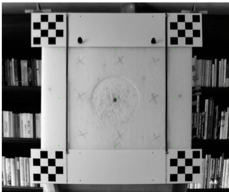
Kalibrierte zentrale Perspektive für eine Kamera und mit der Größe 125 x 105 cm
