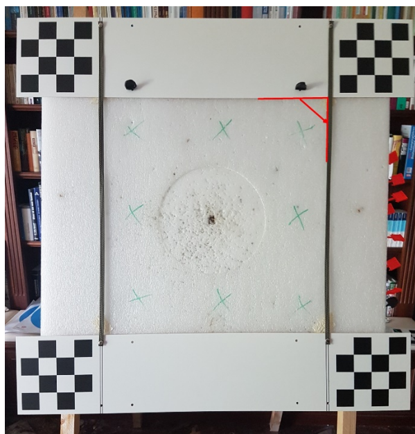
Schachbrett auf einer 80 cm Scheibe, der rechte Winkel ist rot markiert
